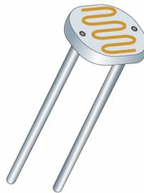
Es un componente electrónico cuya resistencia disminuye con el aumento de intensidad de luz incidente.
